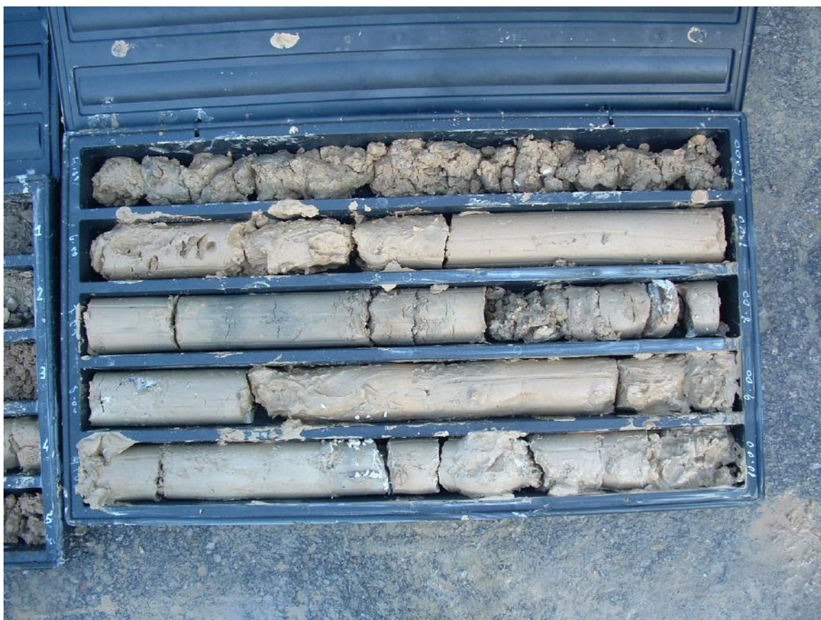
Foto n.3 Cassetta n.2 con materiale estratto tra 5.0m e 10.0m di profondità. La marmettola si presenta di colore variabile dal grigio al beige, con inclusi rari elementi litoidi.
