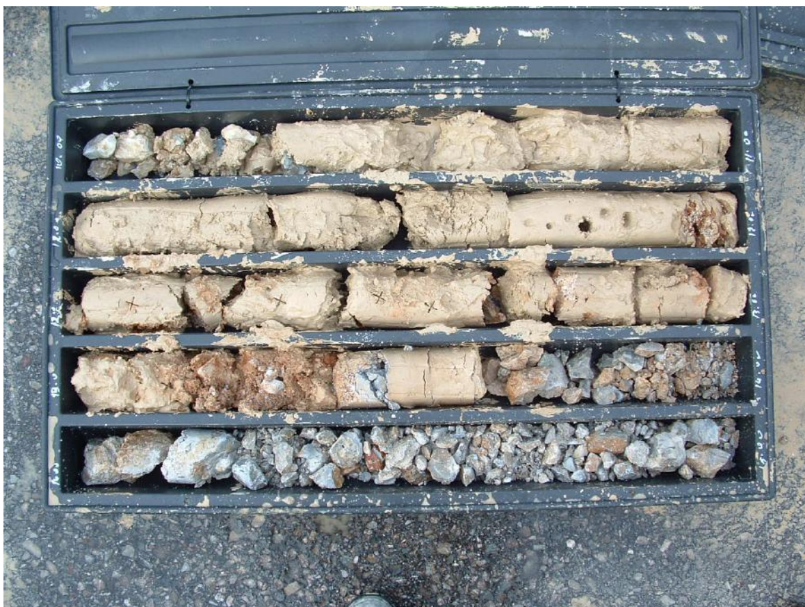
Foto n.4 Cassetta n.3 con materiale estratto tra 10.0m e 15.0m di profondità. Alla profondità di circa 11.9m è presente il substrato roccioso costituito da "calcare cavernoso". Fino alla profondità di 13.6m, avendo usato il carotiere semplice, la carota appare ricoperta esternamente da un velo di marmettola trascinata lungo il foro dalla testa di rotazione.
