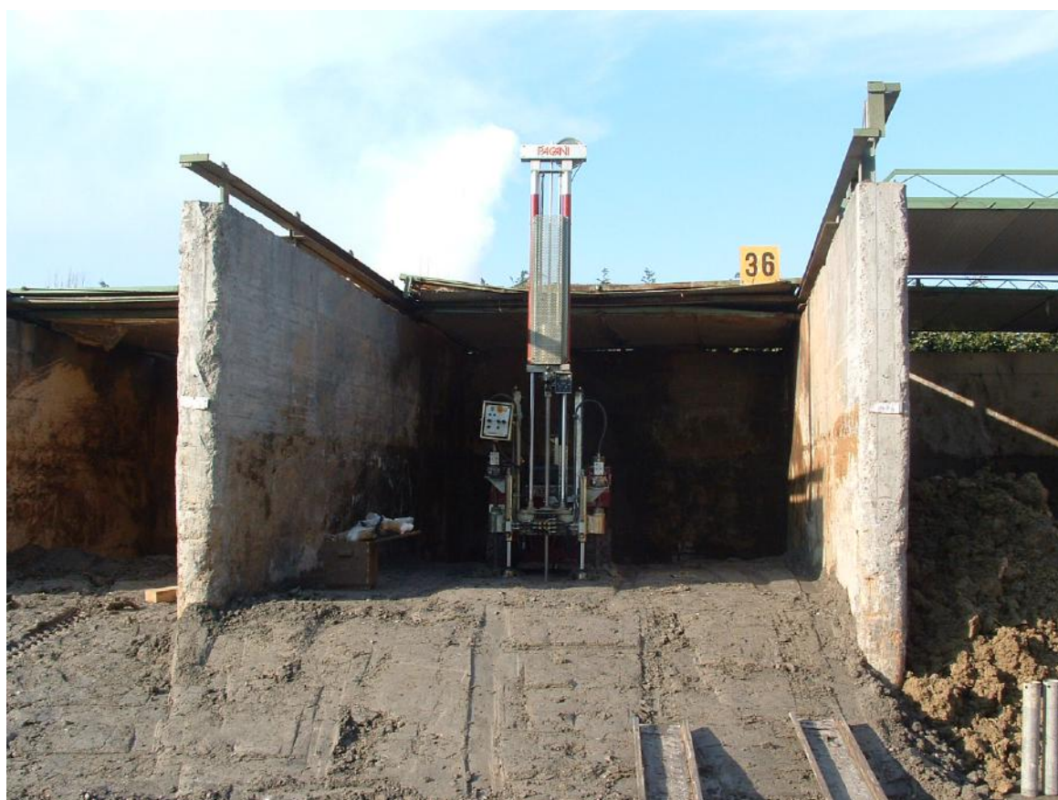
Foto n.2 Prova penetrometrica statica CPT2 , eseguita sulla "Miscela 2".
