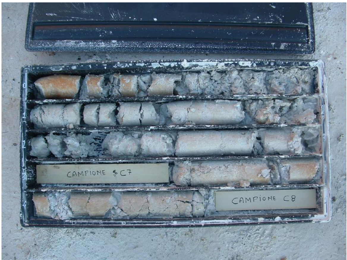
Foto n.2 Cassetta n.1 con materiale, estratto tra 0.0m e 5.0m di profondità, costituito da "marmettola bianca". Alla profondità di 3.0 e 4.7m circa sono stati prelevati due campioni di terreno.
