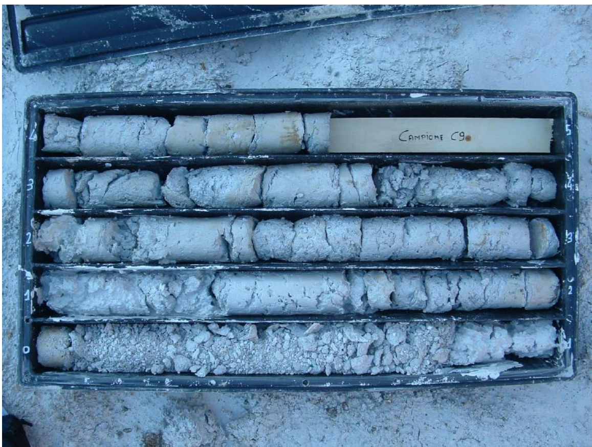
Foto n.2 Cassetta n.1 con materiale, estratto tra 0.0m e 5.0m di profondità, costituito da "marmettola" bianca. Alla profondità di 4.6m circa è stato prelevato un campione di terreno.
