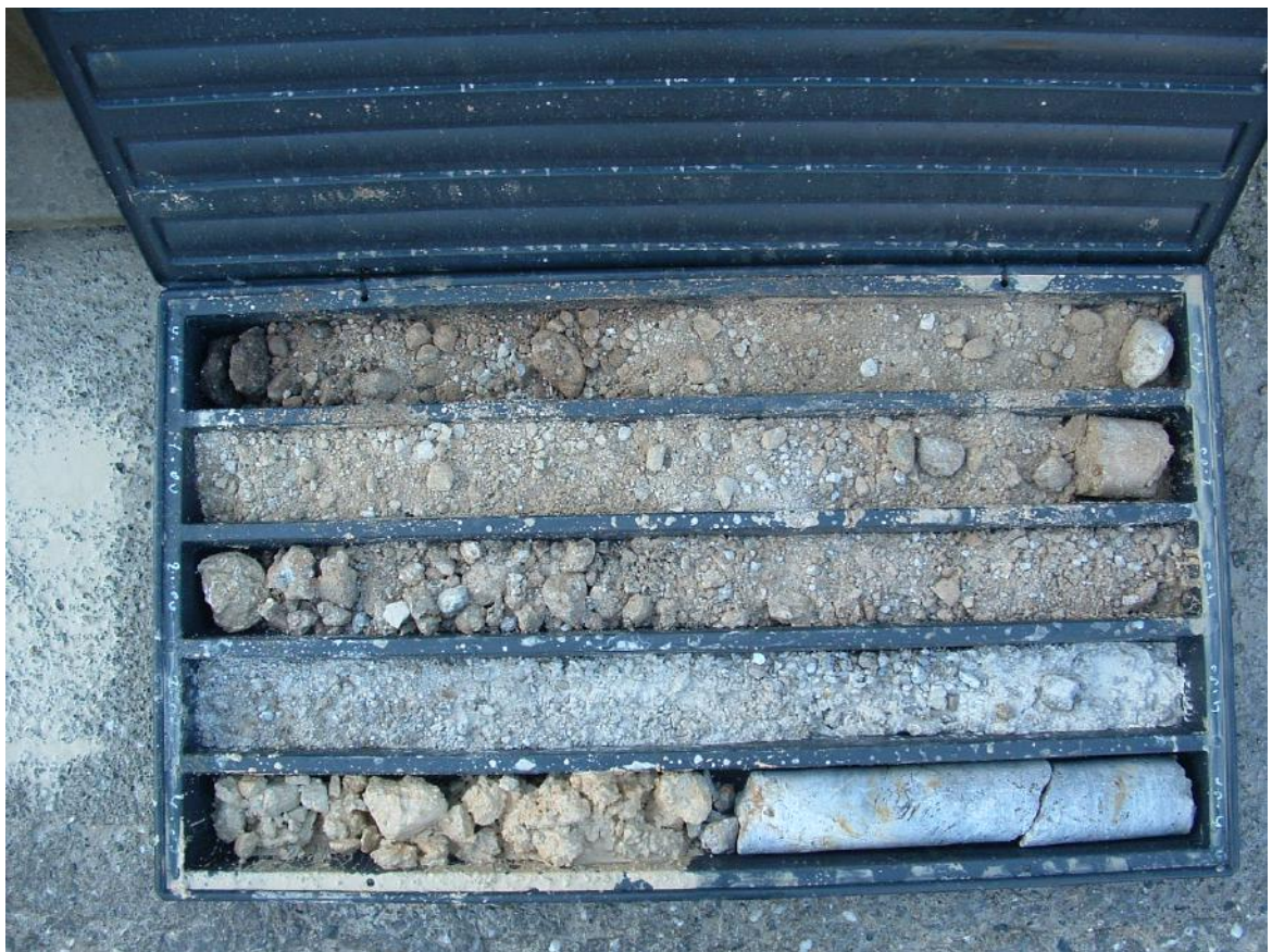
Foto n.2 Cassetta n.1 con materiale estratto tra 0.0m e 5.0m di profondità. Alla profondità di 4.5m è presente il substrato roccioso, costituito da "calcare cavernoso".
