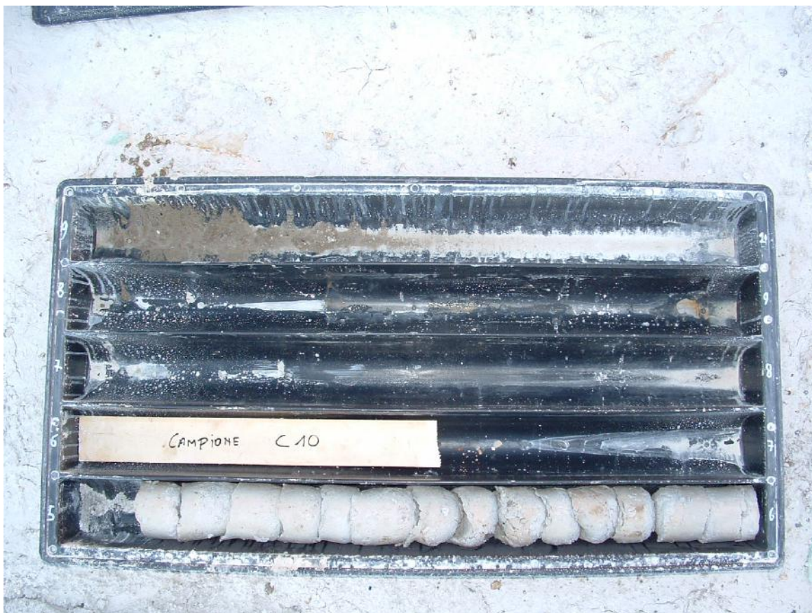
Foto n.3 Cassetta n.2 con materiale, estratto tra 5.0m e 6.5m di profondità, è costituito da "marmettola" bianca. Alla profondità di 6.0m è stato prelevato un campione di terreno.
