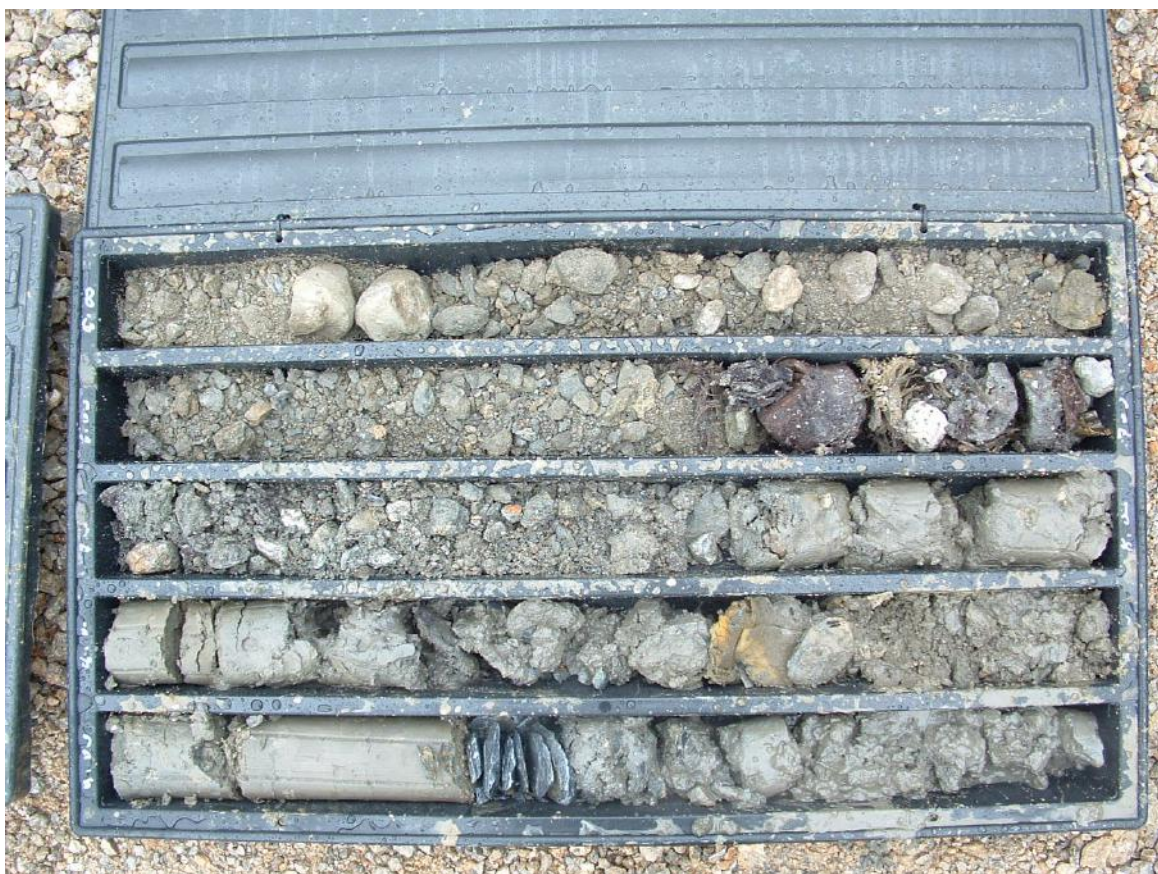
Foto n.3 Cassetta n.2 con materiale estratto tra 5.0m e 10.0m di profondità. Dalla profondità di 7.6m le carote estratte sono costituite da materiale di natura più coesiva, rispetto a quelle superficiali.
