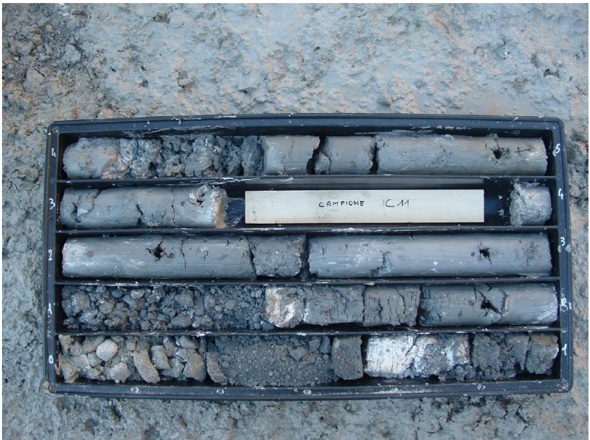
Foto n.2 Cassetta n.1 con materiale, estratto tra 0.0m e 5.0m di profondità, costituito da "marmettola" grigio-scura. Alla profondità di 3.3m circa è stato prelevato un campione di terreno.
