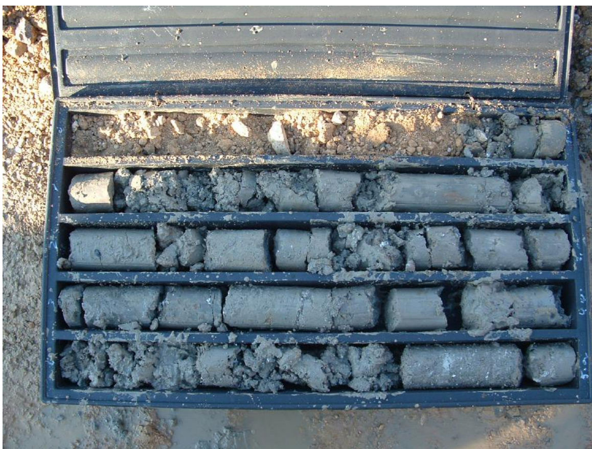
Foto n.2 Cassetta n.1 con materiale estratto tra 0.0m e 5.0m di profondità. Alla profondità di 1.0m inizia il deposito di rifiuto misto.
