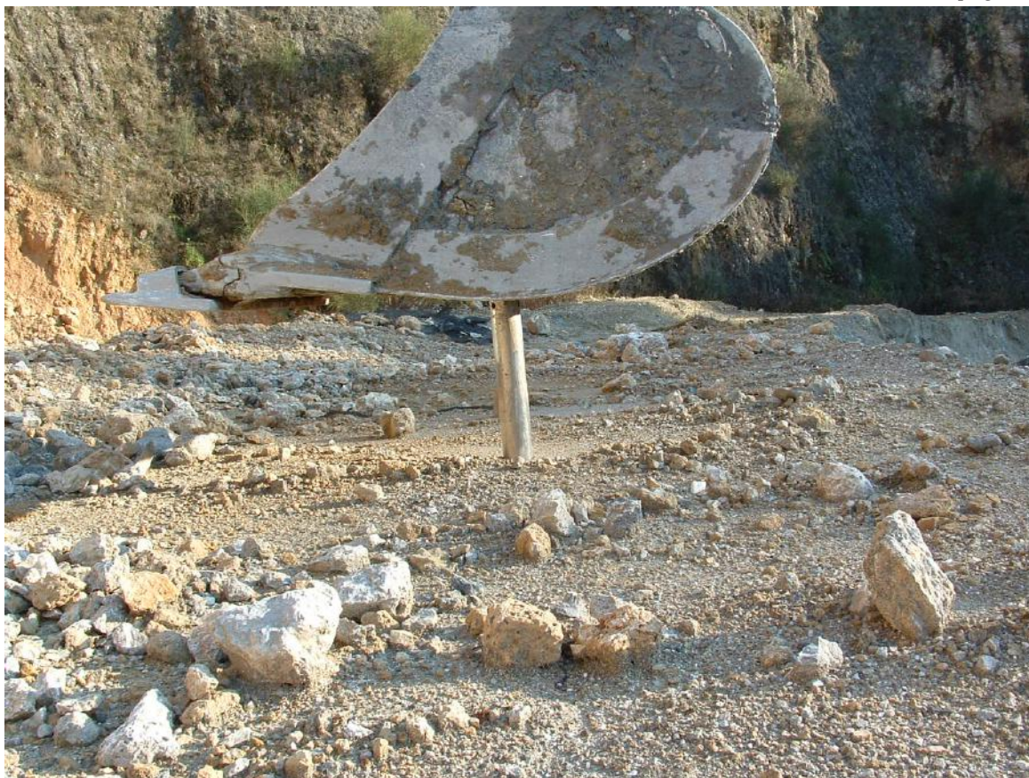
Foto n.1 Prelievo del campione C19 con benna meccanica, sull'argine del "lotto C".
