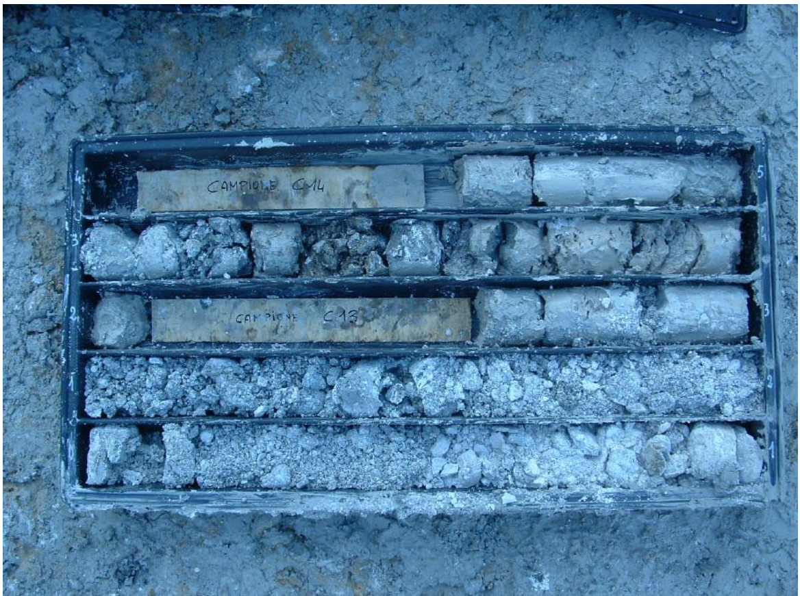
Foto n.2 Cassetta n.1 con materiale, estratto tra 0.0m e 5.0m di profondità, costituito da "marmettola" di colore variabile dal grigio chiaro al grigio-scuro. Alla profondità di 2.1m e 4.0m, sono stati prelevati due campioni di terreno.
