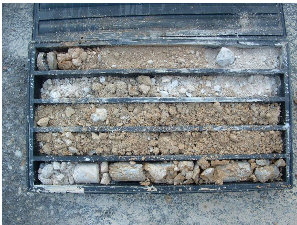
Foto n.2 Cassetta n.1 con materiale estratto tra 0.0m e 5.0m di profondità. Alla profondità di 4.0m è presente il substrato roccioso costituito da "calcare cavernoso".
