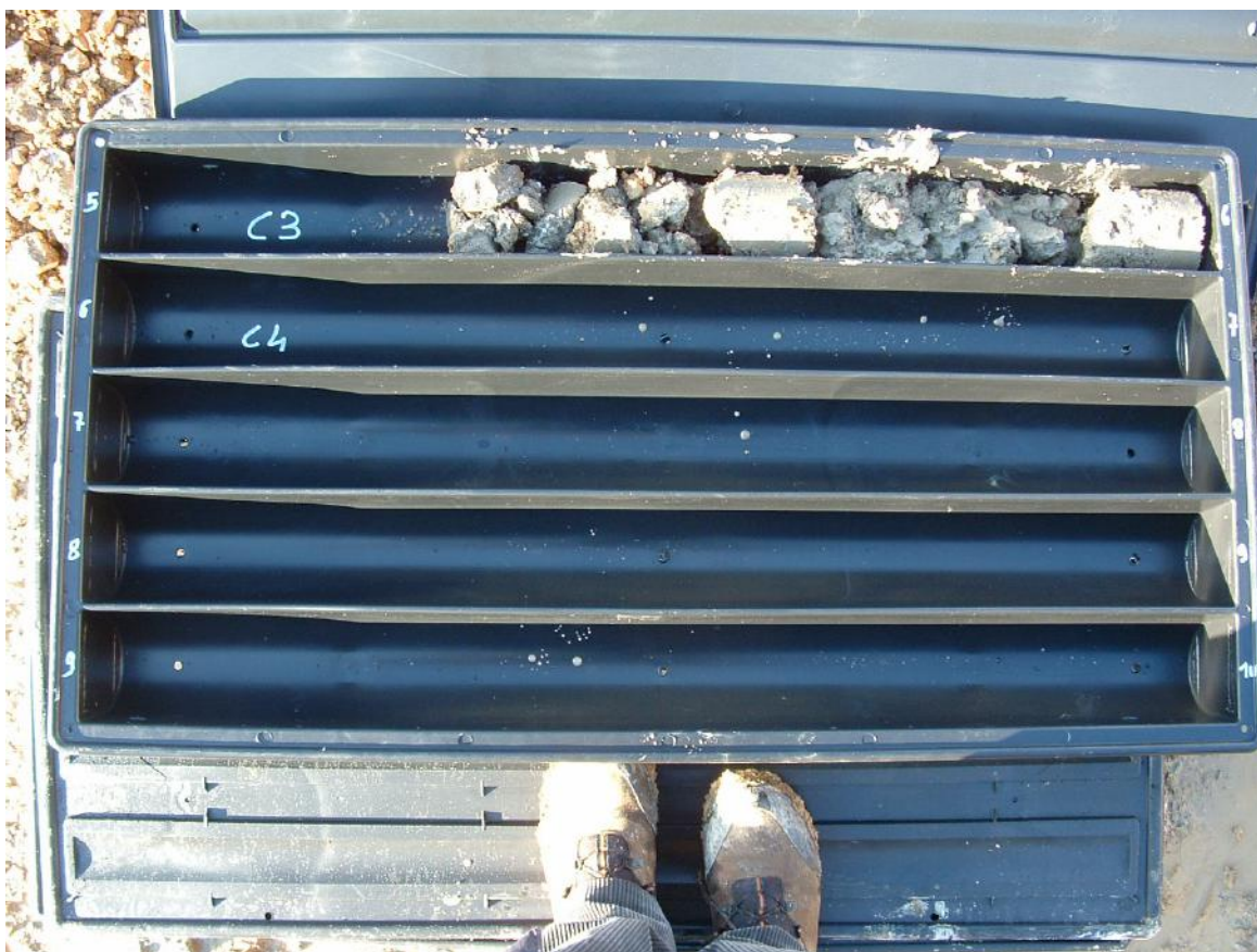
Foto n.3 Cassetta n.2 con materiale estratto tra 5.0m e 6.4m di profondità. Alla profondità di 5.0m e 6.0m sono stati prelevati due campioni indisturbati, con fustella Shelby.
