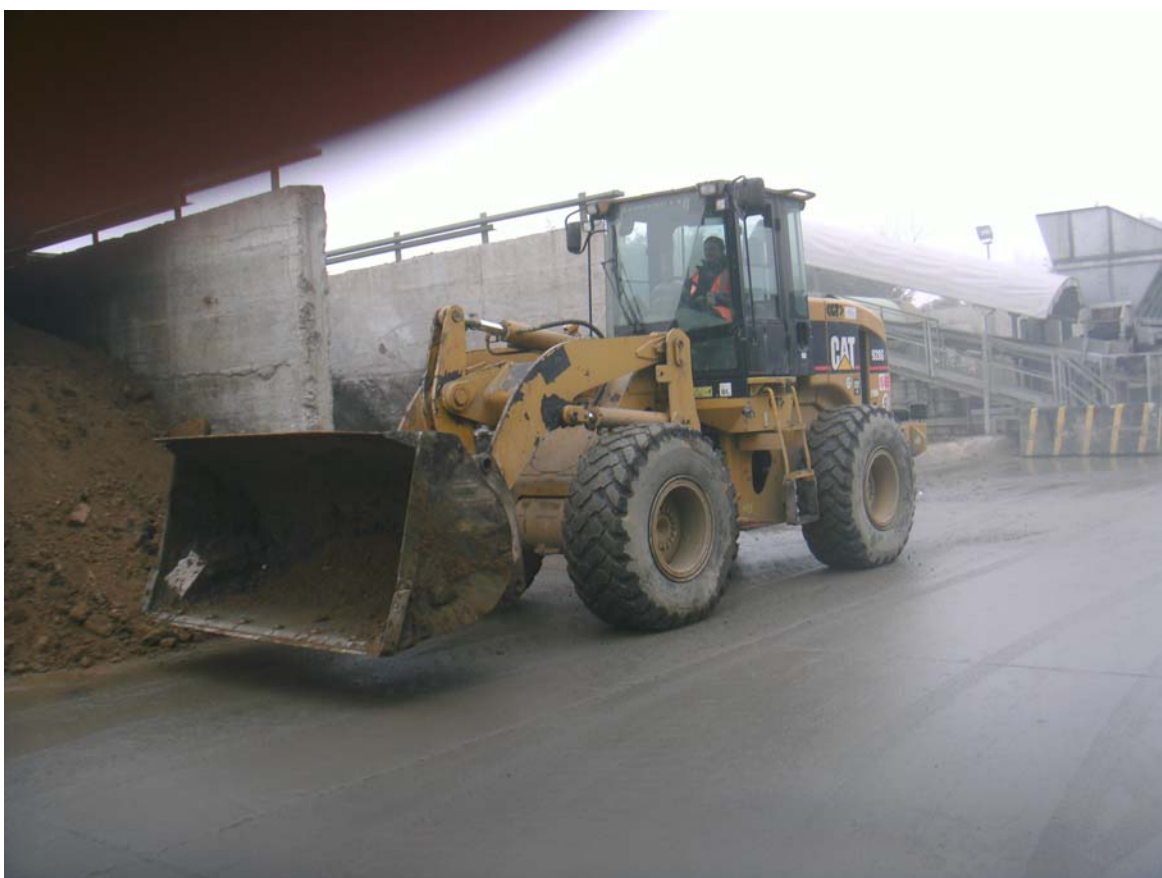
Foto n.4 Pala gommata con cella di pesatura, utilizzata per caricare il materiale nel miscelatore.
