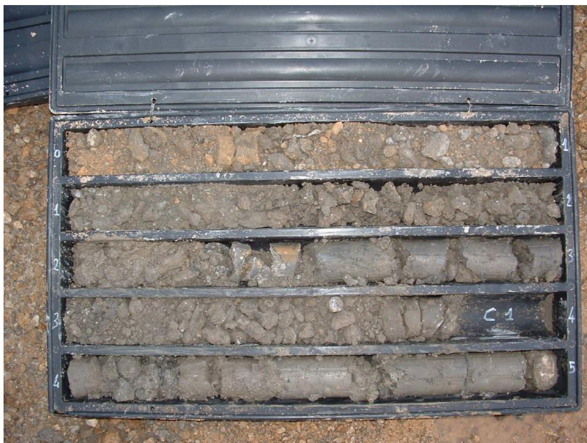
Foto n.2 Cassetta n.1 con materiale estratto tra 0.0m e 5.0m di profondità. Alla profondità di 1.0m inizia il deposito di rifiuto misto.
