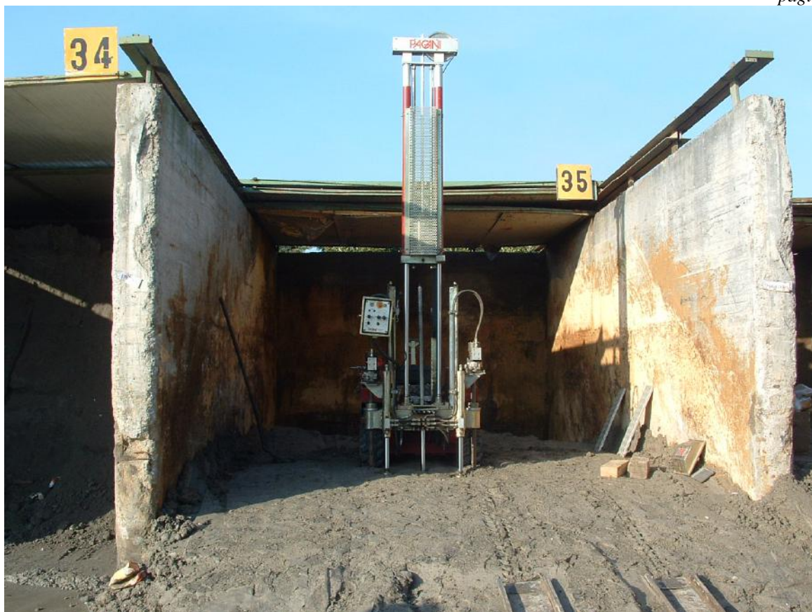
Foto n.1 Prova penetrometrica statica CPT1 , eseguita sulla "Miscela 1".
