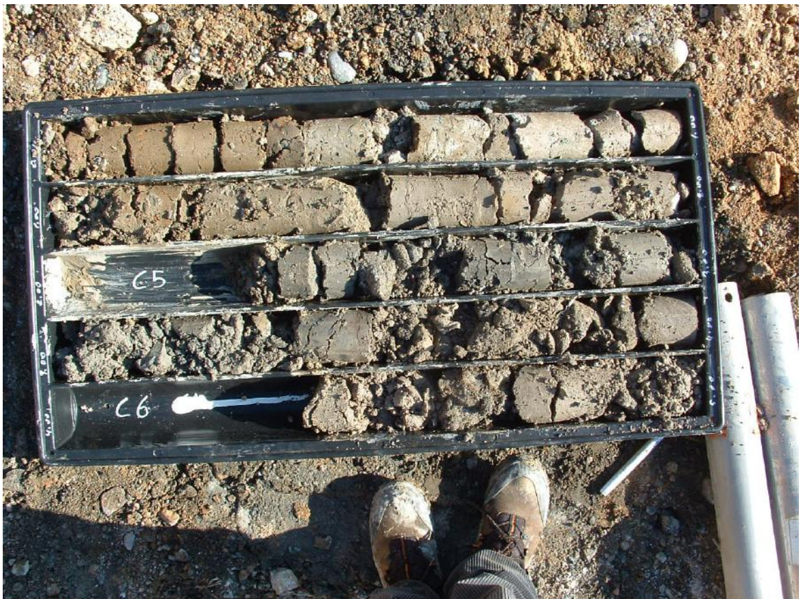
Foto n.2 Cassetta n.1 con materiale estratto tra 0.0m e 5.0m di profondità. Alla profondità di 2.0m e 4.0m sono stati prelevati i due campioni, denominati C5 e C6.
