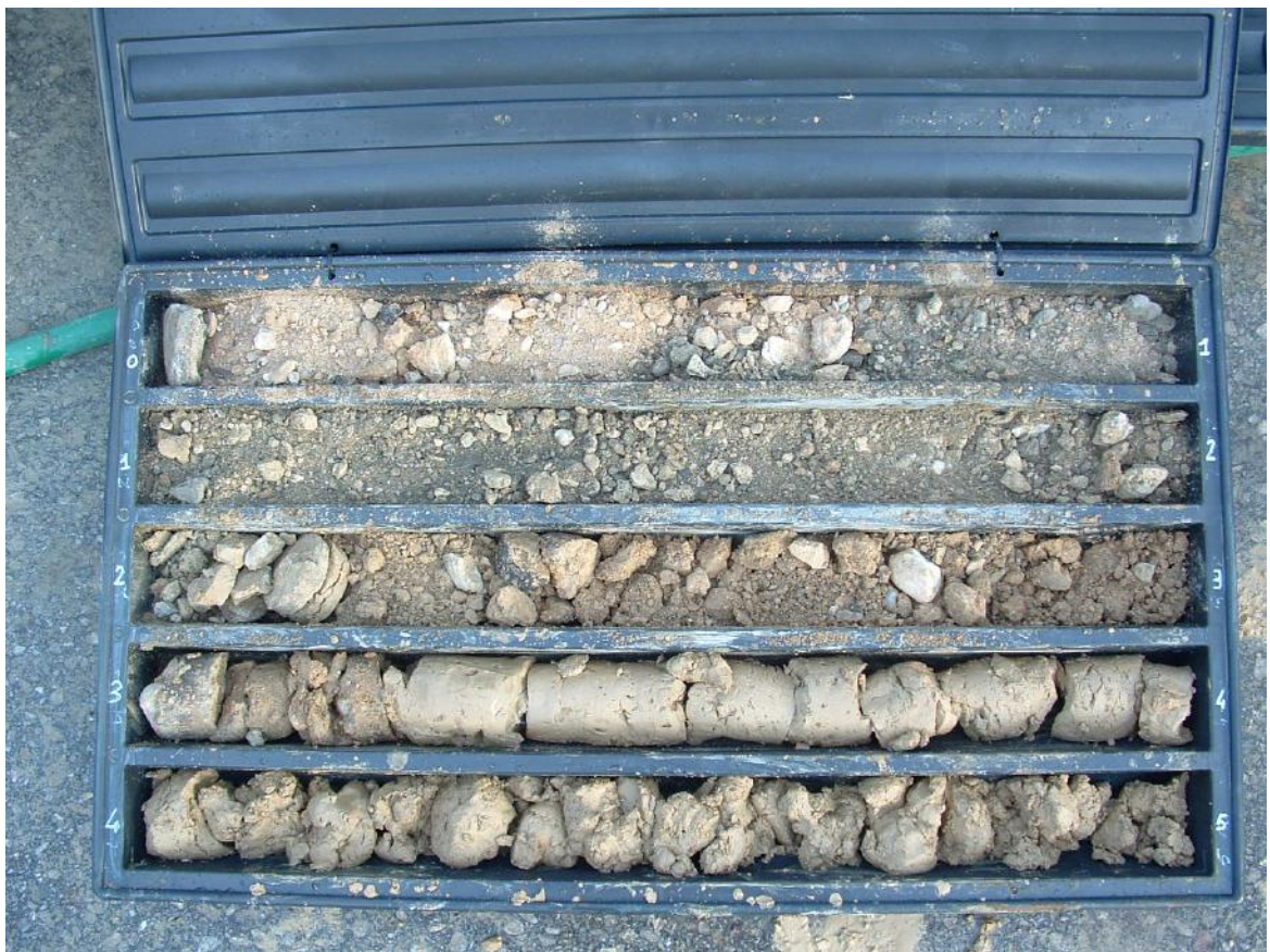
Foto n.2 Cassetta n.1 con materiale estratto tra 0.0m e 5.0m di profondità. Alla profondità di 3.2m inizia il deposito di "marmettola", di natura coesiva.
