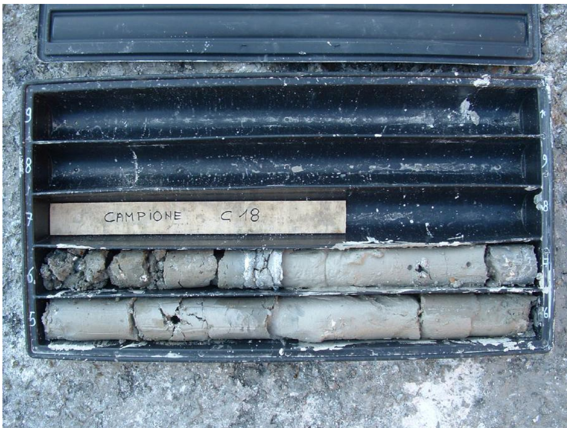
Foto n.3 Cassetta n.2 con materiale estratto tra 5.0m e 7.6m di profondità. Alla profondità di 7.0m è stato prelevato un campione di terreno.
