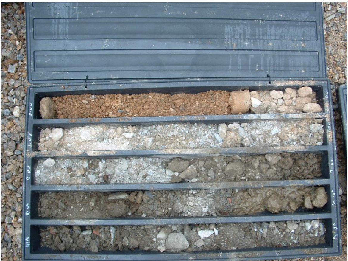
Foto n.2 Casseta n.1 con materiale estratto tra 0.0m e 5.0m di profondità. Alla profondità di 2.5m inizia il terreno di riporto, stoccato a seguito dell'alluvione del 1996 in Versilia.
