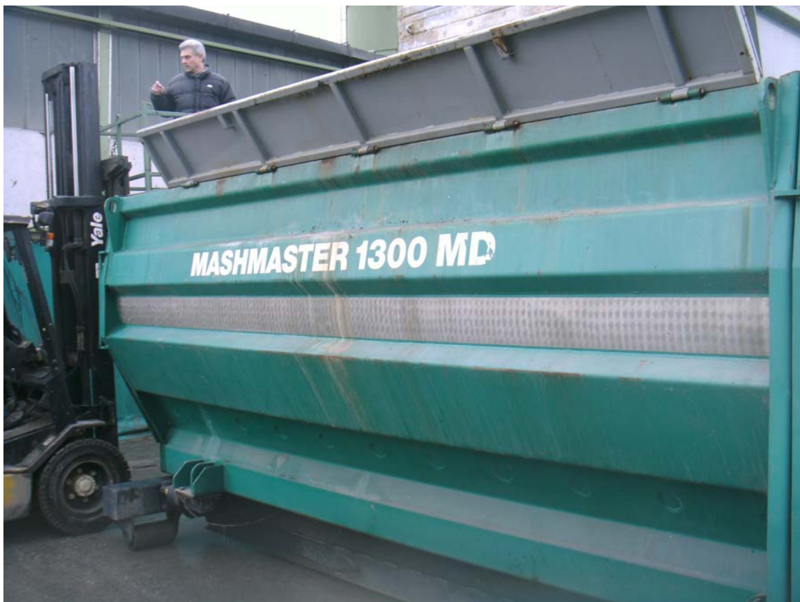
Foto n.5 Miscelatore a triplice coclea munito di cella di pesatura della ditta Komptech, tipo MASHMASTER 1300 MD.
