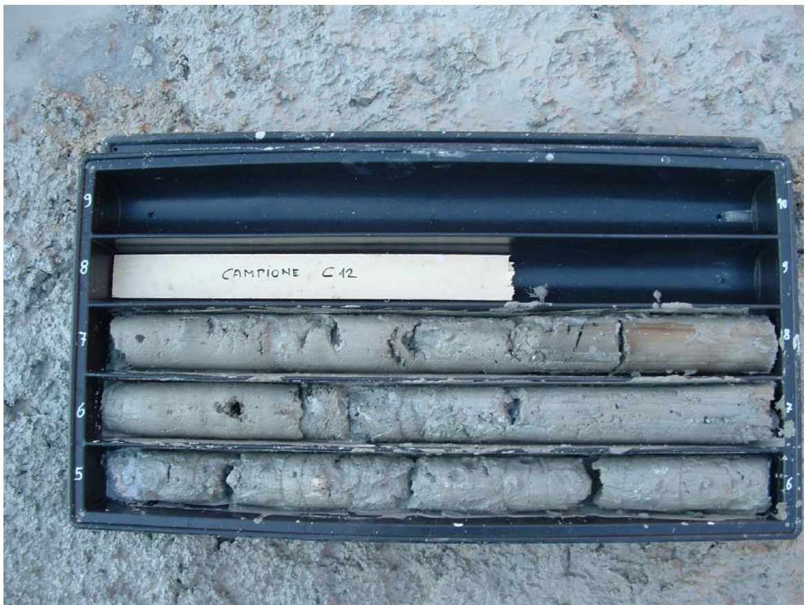
Foto n.3 Cassetta n.2 con materiale, estratto tra 5.0m e 8.6m di profondità, costituito da "marmettola" più chiara. Alla profondità di 8.0m è stato prelevato un campione di terreno.
