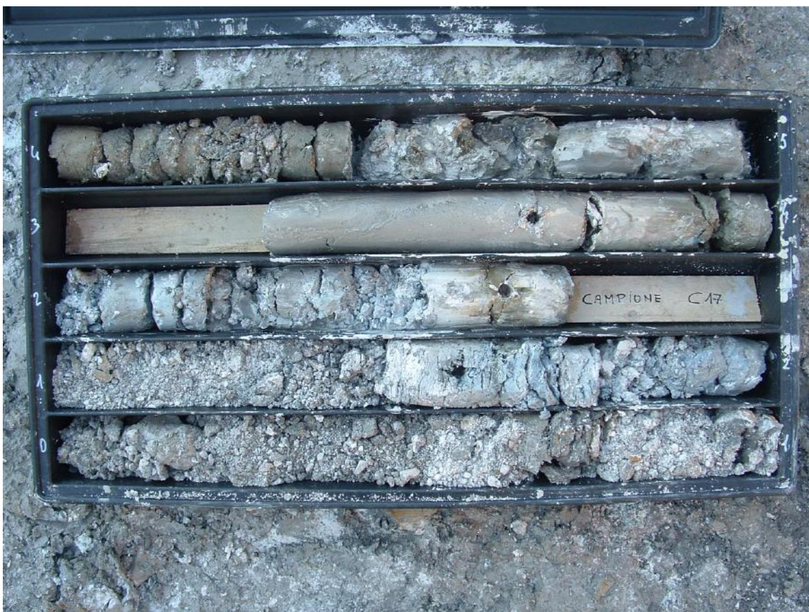
Foto n.2 Cassetta n.1 con materiale, estratto tra 0.0m e 5.0m di profondità, costituito da "marmettola" di colore variabile dal grigio chiaro al grigio-scuro. Alla profondità di 2.7m è stato prelevato un campione di terreno.
