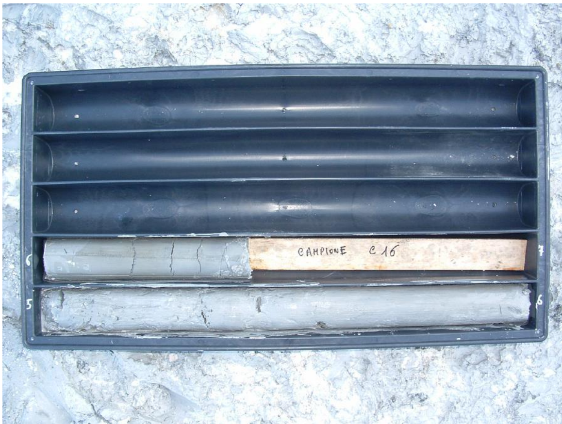
Foto n.3 Cassetta n.2 con materiale estratto tra 5.0m e 7.0m di profondità. Alla profondità di 6.4m è stato prelevato un campione di terreno.
