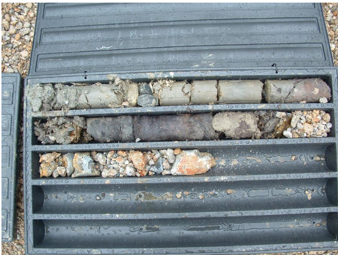
Foto n.4 Cassetta n.3 con materiale estratto tra 10.0m e 13.6m di profondità. Alla profondità di circa 11.9m è presente il substrato roccioso, costituito da "calcare cavernoso".
