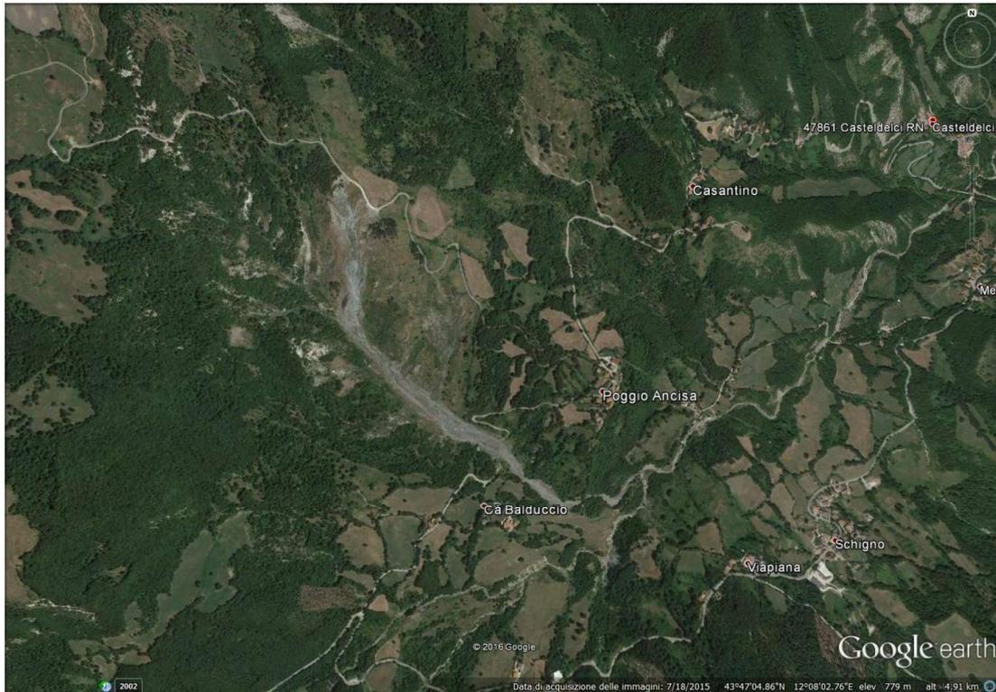
Fig. 6 – La frana di Poggio Ancisa del 2009 emblematica dell'instabilità diffusa del tipo di substrato in cui dovrebbe insediarsi l'impianto progettato, che determinerebbe un rischio elevato per il territorio nonché per la viabilità, le infrastrutture, gli insediamenti sparsi, le reti idriche artificiali e per l'idrogeologia.
