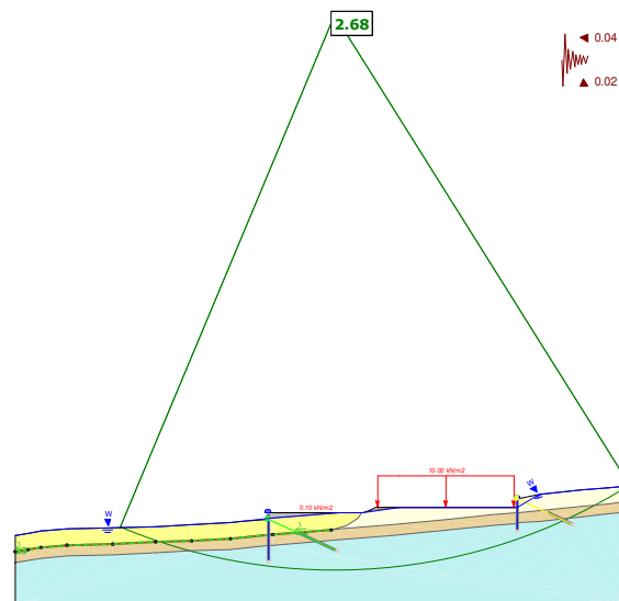
Figura 3-15: Sezione 2, caso 2f, stabilità dell'area complessiva della postazione con sisma. Superficie di minima sicurezza.
