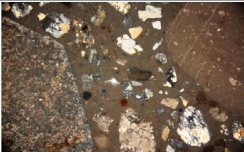
**Campione: S5-C2***Foto n. 1 - Foto al microscopio ottico, sezione sottile, luce trasmessa, 20 ingrandimenti, nicols incrociati*
