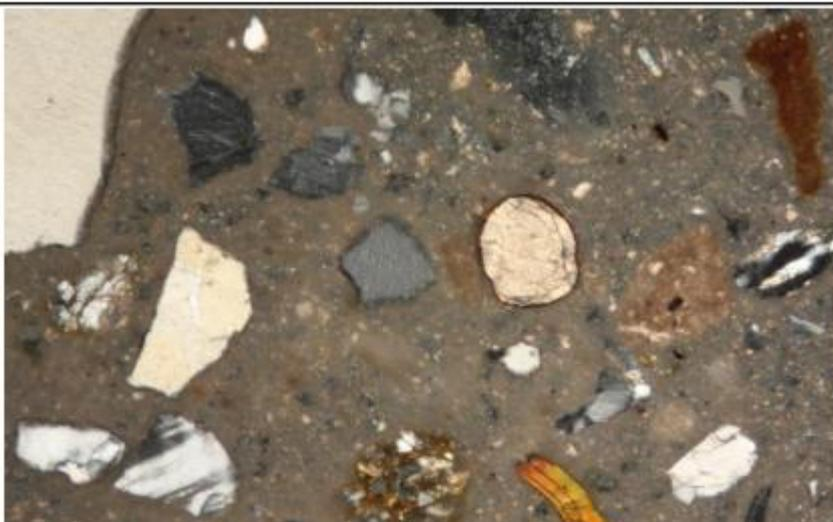
**Campione: S5-C1***Foto n. 2 - Foto al microscopio ottico, sezione sottile, luce trasmessa, 40 ingrandimenti, nicols incrociati*
