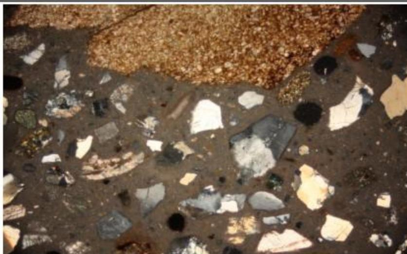
**Campione: S5-C1***Foto n. 1 - Foto al microscopio ottico, sezione sottile, luce trasmessa, 20 ingrandimenti, nicols incrociati*
