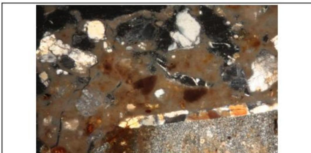
**Campione: S2-C1***Foto n. 2 - Foto al microscopio ottico, sezione sottile, luce trasmessa, 40 ingrandimenti, nicols incrociati*
