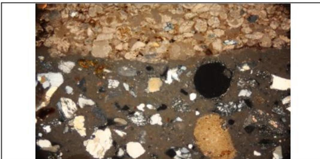
**Campione: S4-C2***Foto n. 1 - Foto al microscopio ottico, sezione sottile, luce trasmessa, 20 ingrandimenti, nicols incrociati*
