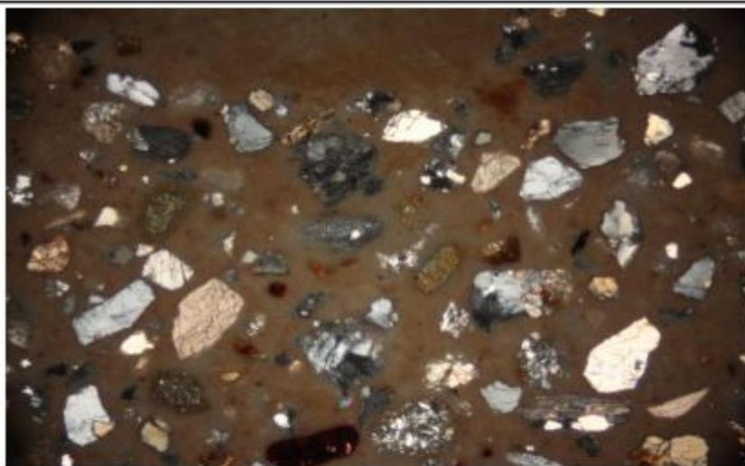
**Campione: S3-M1***Foto n. 1 - Foto al microscopio ottico, sezione sottile, luce trasmessa, 20 ingrandimenti, nicols incrociati*
