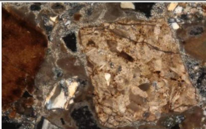
**Campione: S10-M1***Foto n. 2 - Foto al microscopio ottico, sezione sottile, luce trasmessa, 40 ingrandimenti, nicols incrociati*
