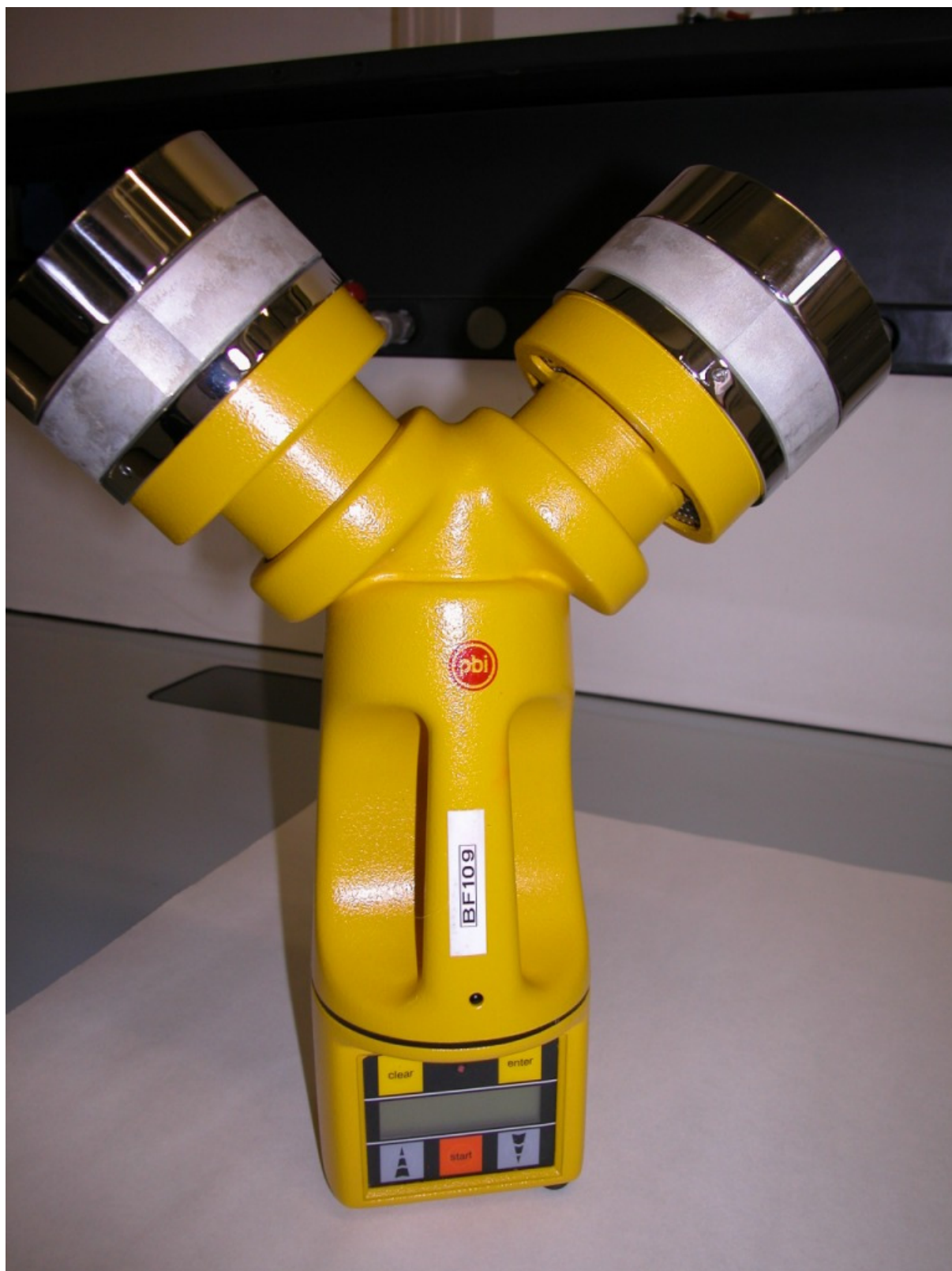
foto 4: campionatore SAS (Surface Air System) a due testate della Ditta International Pbi
