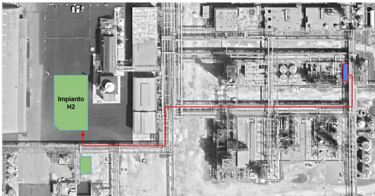
Percorso della tubazione di acqua demineralizzata
