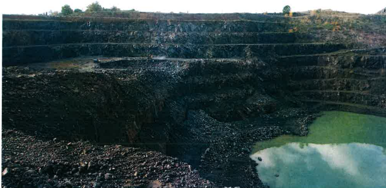
Foto 8: Lavori di realizzazione in corso della rampa dal piano 0 (dove sono i vari mezzi d'opera) al piano -10
