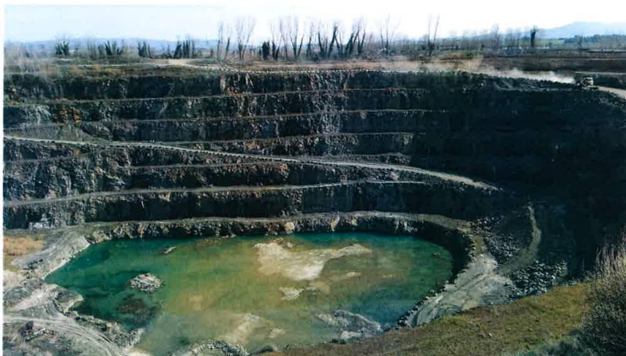
Foto 2: Parte terminale della gradonatura Est con fondo scavo parzialmente allagato
