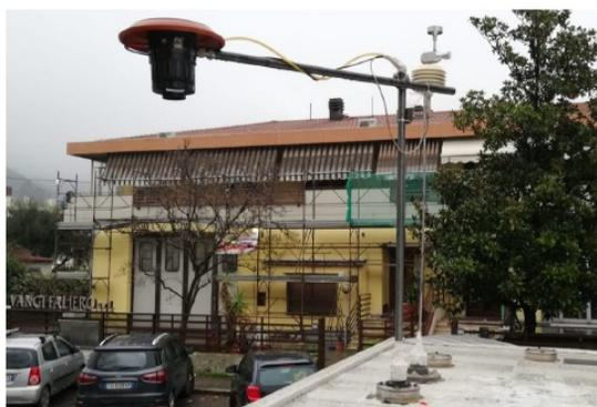
Figura n.22 Foto del sito di campionamento, dove è possibile osservare sia il campionatore sequenziale (foto sulla sinistra) che il campionatore orario sul mezzo mobile
