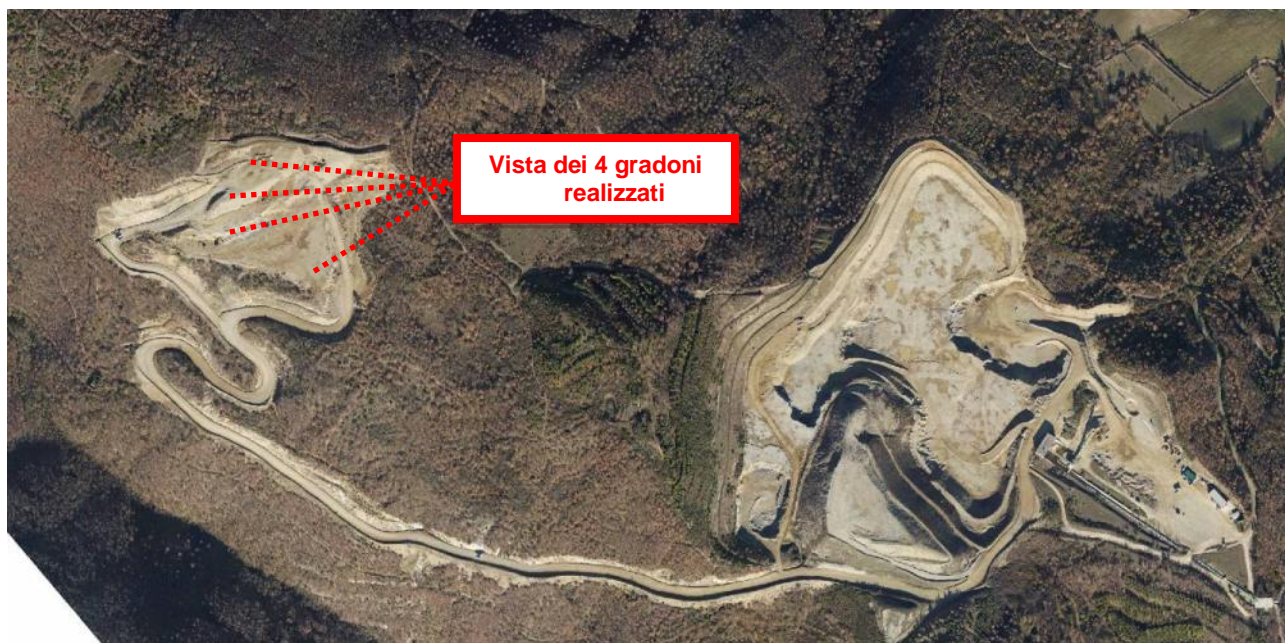
Figura 9 - Stato realizzato del cantiere relativo alla Concessione 2009 - vista dei 4 gradoni
