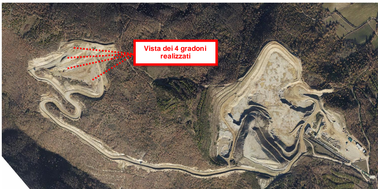
Figura 5 - Stato realizzato del cantiere relativo alla Concessione 2009 - vista dei 4 gradoni
