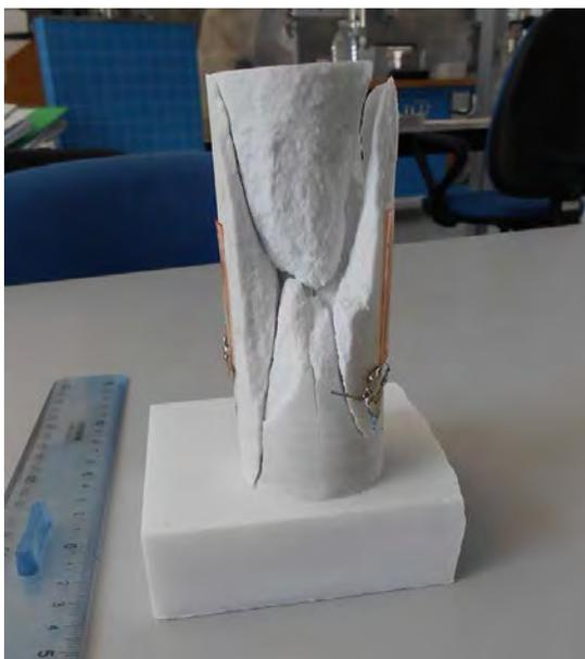
Figura 13 - Immagine del provino a termine della prova utilizzato per il test di compressione uniassiale e la misura della deformazione.
