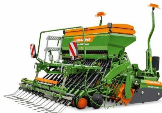
Figura 5-21. Attrezzature per la semina: seminatrice combinata
