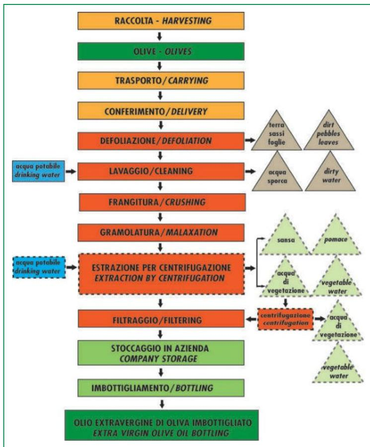
Diagramma di flusso per la produzione di olio extra vergine di oliva.
